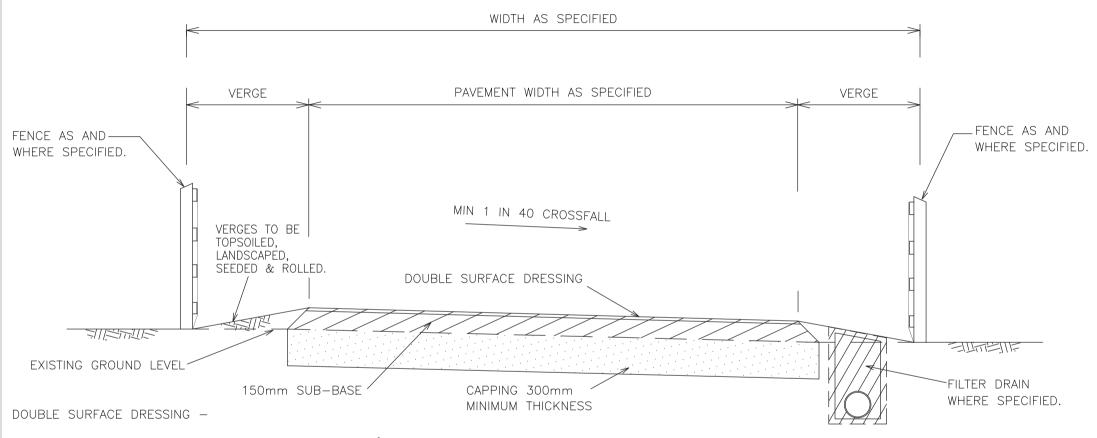
6mm CRUSHED ROCK CHIPPINGS AT RATE OF 6-8  $\rm l/m^{~2}$  AND C69B3 CATIONIC BITUMINOUS EMULSION AT RATE OF 1.3 TO 1.6  $\rm l/m^{^2}$
